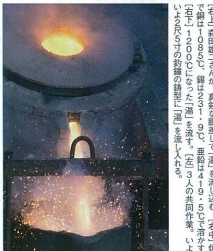
「右上」森田雄一さんが、真剣な眼差しで「湯」を流し込む。 「右中」炉で銅は1,085℃、錫は231・9℃、亜鉛は419・5℃で溶かす。 「右下」1,200℃になった「湯」を流す。 「左」3人の共同作業。 いよいよ2尺5寸の釣鐘の鋳型に「湯」を流し入れる。
